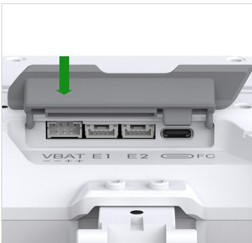
Externer Stromanschluss (21 V–26 V)
