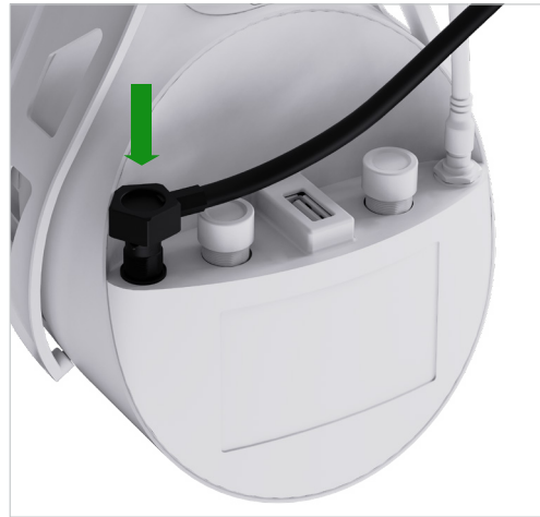
② Antennenkabel anschließen
